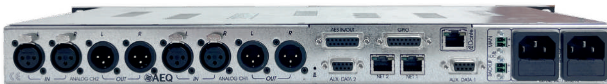
Dos pares de entradas y salidas de audio analógicas L y R, doble entrada y salida AES3, dos puertos serie de datos auxiliares, 4 GPI, 6 GPO, dos puertos de red (NET1 y NET2) y un tercer puerto de red AoIP Dante, fuentes de alimentación (Hasta dos AC y dos DC a 48 v.).
