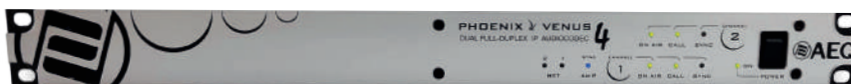
Indicadores del estado de las redes y las comunicaciones, interruptor y piloto de red.
