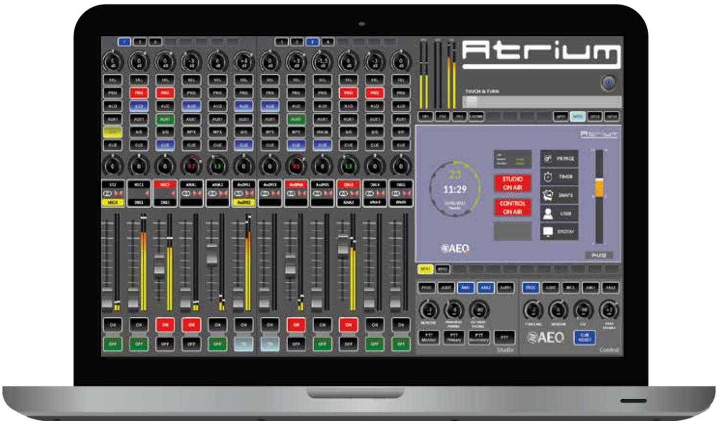
Sobre cada superficie de control se puede abrir una ventana diferenciada de Virtual Atrium. Así en superficies de control que compartan un único motor X\_CORE, se puede utilizar simultáneamente un Virtual Atrium sobre cada superficie.
