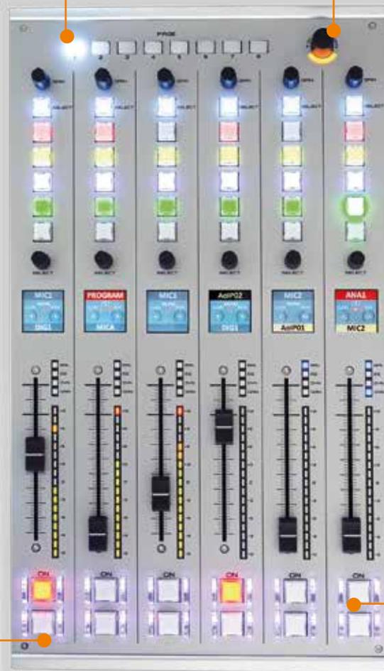
Junto a las teclas de cambio de página hay un encoder de touch & tourn para hacer ajustes precisos sobre la pantalla táctil.
