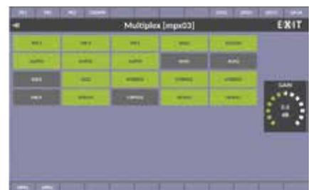
Si no se ha asociado una pantalla TFT opcional al módulo de faders, cuando se pulsa la tecla SELECT de un canal, las opciones de configuración para este fader, se presentarán en el TFT principal del módulo de control.
