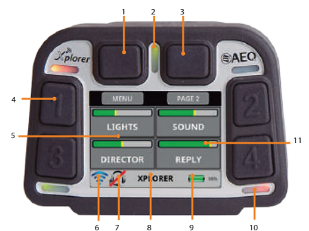
1 Tecla programable. 2 Indicador de estado. 3 Tecla programable. 4 4 teclas de acceso directo programables, o de selección de canal en modo Party-Line. 5 Pantalla TFT de 2.4". 6 Indicador nivel señal Wi-Fi. 7 Indicador mute. 8 Etiqueta nombre del terminal. 9 Indicador nivel batería. 10 4 indicadores LED de modo. 11 Indicador nivel de entrada de cada interlocutor.
