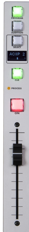
Detalle modulo de canal en superficie de control de AEQ CAPITOL IP
