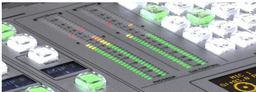
Detalle vúmetros de Control
