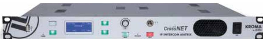
**CrossNET** es una solución integrada y compacta de intercom. En una unidad de rack disponemos de una matriz basada principalmente en tecnología AoIP con el estándar Dante™ y compatible con AES67, capaz de gestionar hasta 190 x190 canales de audio con procesamiento interno de la señal de calidad broadcast.
