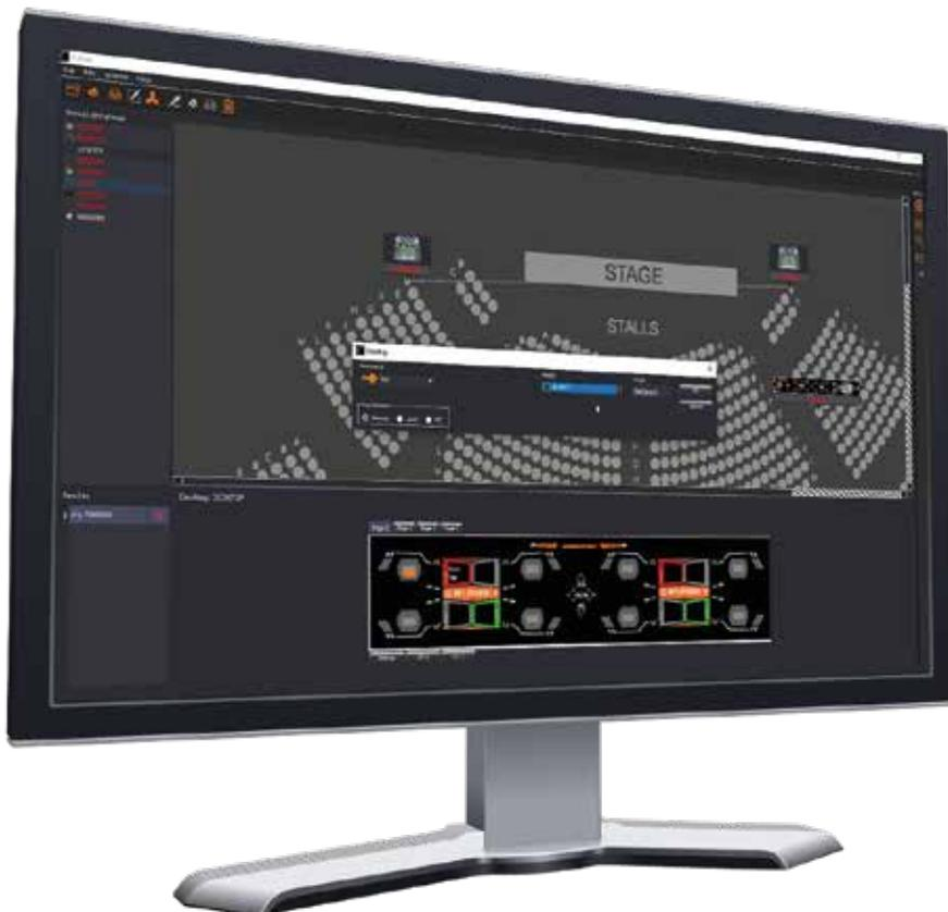
Cada uno de los componentes de Xpeak incorpora funciones de autodescubrimiento y autoconfiguración. Si un sistema sale completo de fábrica, todos sus terminales estarán listos para operar en unas condiciones básicas, lo que no quita la necesidad de adaptar su funcionamiento a las necesidades particulares de cada ámbito de trabajo. Para esto, se ha desarrollado una aplicación de configuración, en base a estas características:
