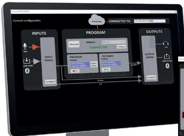
**CONTROL PHOENIX** facilita el enrutamiento del audio, el modo de transmisión el establecimiento de la llamada y la medida de los niveles de audio entrante y saliente a cada codec.
