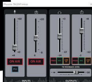
**CONTROL PHOENIX para TALENT**, además incorpora la ventana del mezclador de sonido, que permite regular remotamente el volumen de cada fuente de sonido, además de seleccionar las fuentes que se envían a cada salida.
