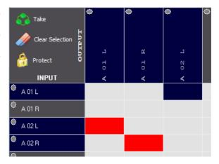
Si se selecciona un conjunto de puntos de cruce en el que hay puntos activos e inactivos (se marcarán en rojo y en verde respectivamente) y se ejecuta "Take", la aplicación "NetboxRTC" ejecutará tanto las conexiones como las desconexiones, es decir, es posible activar y desactivar múltiples puntos de cruce con la misma acción "Take".
