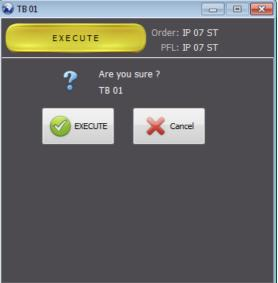
Al ejecutarlo se eliminan todos los puntos de cruce hechos hacia las líneas de salida que forman parte del "Talkback" (tanto hacia la línea definida como "PFL" como hacia las definidas como "Talk") y, únicamente en el caso de un NETBOX DSP, se restauran las ganancias a 0 de todos los puntos de cruce (ya estén activados o no) hacia esas líneas de salida.
