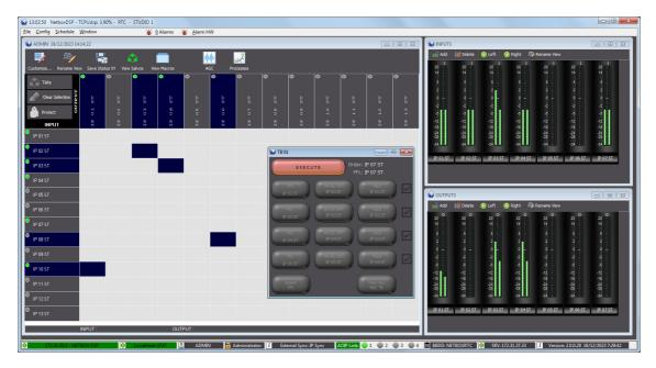
Al ejecutar el "Talkback" **TB 01** los 3 puntos de cruces situados más a la izquierda se eliminan porque esas líneas de salidas forman parte del "Talkback" seleccionado y se crean las conexiones n-1 correspondientes:
