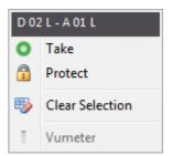
Para cada punto de cruce se puede ejecutar la acción "**Take**" (activar o desactivar) o "**Protect**" (proteger o desproteger), y también ver las conexiones físicas (entrada conectada a la salida). La opción "**Clear Selection**" borrará cualquier selección de puntos de cruce en la vista XY.
