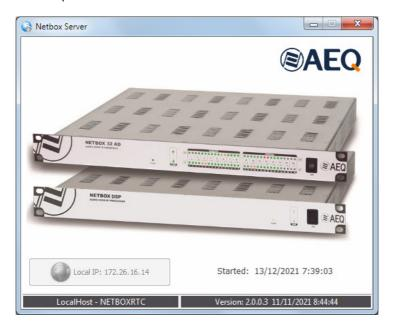
En la parte inferior de esa pantalla aparece indicada la dirección IP que se va a usar para la conexión con el equipo NETBOX (esa dirección IP deberá estar en el mismo rango que la del equipo). Aparece también la fecha y hora de inicio de la aplicación y, en la línea inferior, la base de datos a la que estamos conectados y la versión de la aplicación junto con la fecha y hora de compilación.
