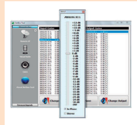
Figura 1. Ajustes de ganancias de audio en Netbox Tool.
