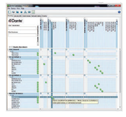
Figura 3. Netbox 32 configurado en Dante Controller para comunicarse con 3 unidades de comentarista Olympia 3.
