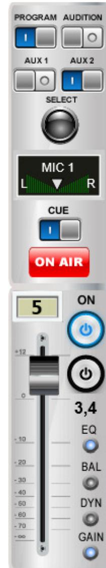
Cuando se pulsa el botón "SELECT" de un canal, en la parte superior de la pantalla de control remoto los vúmetros "PROGRAM" y "AUDITION" se desplazan hacia la derecha (ocultando los vúmetros "AUX 1", "AUX 2", "MPX 1" y "MPX 2") y aparece una ventana que muestra el estado del canal seleccionado. Para volver a la situación anterior, sólo hay que pulsar de nuevo el botón "SELECT" del canal.
