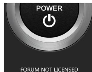
Si la conexión con la consola se ha realizado correctamente, a continuación se verifica si tiene activada la licencia para usar "**AEQ FORUM SCREEN**". La licencia reside en la consola, no en el software, por lo que un mismo software funcionará o no dependiendo de la consola a la que se conecte.
