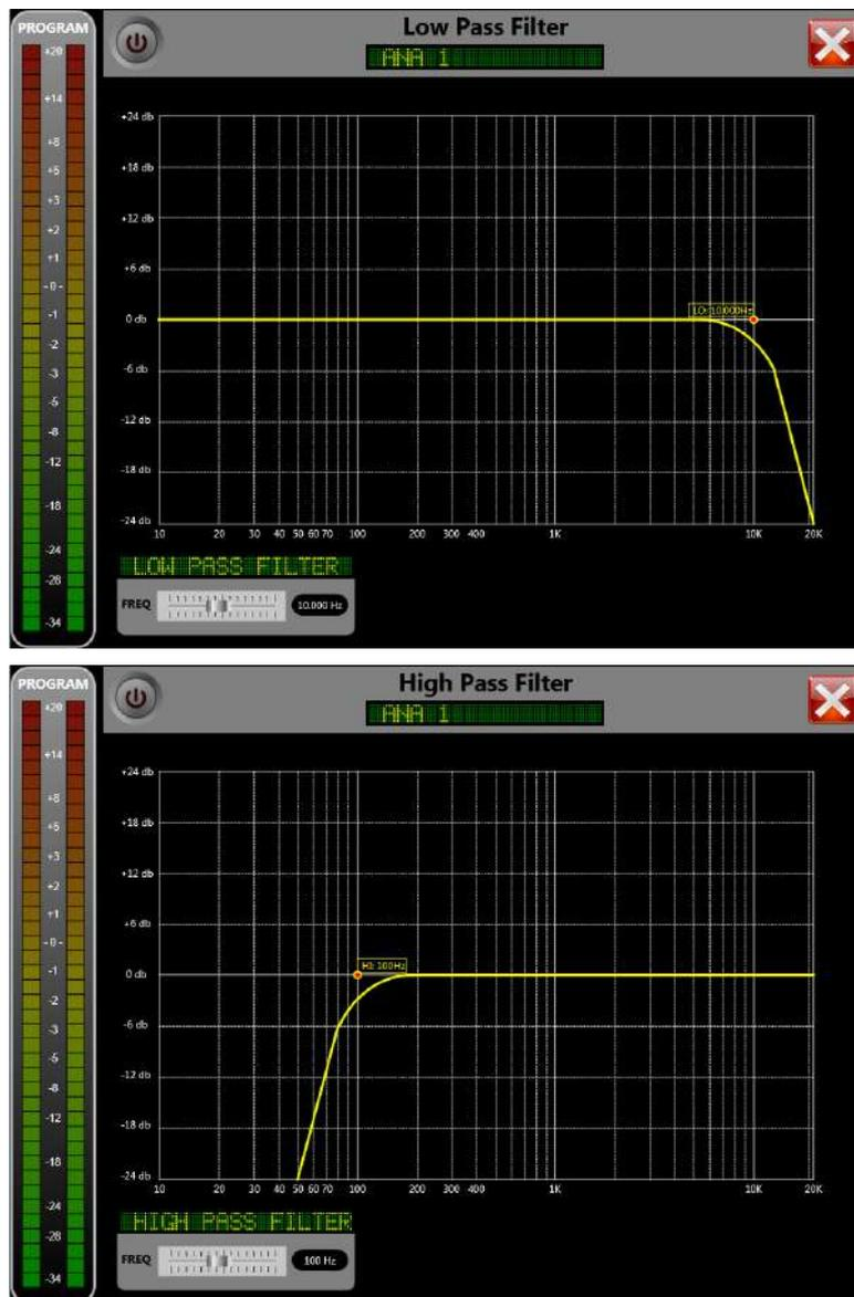
En estas pantallas es posible activar o desactivar el filtro paso bajo (LPF) y el paso alto (HPF) y cambiar la frecuencia de corte de cada uno de ellos.
