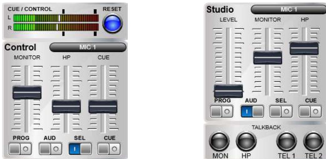
En la parte superior de la sección de Control se muestra el vúmetro de CUE (o del bus de monitorado de control, si no hay ningún envío a CUE activo) y, junto a él, un botón con la función "CUE RESET", que funciona en paralelo con el configurado en la zona de teclas programables.
