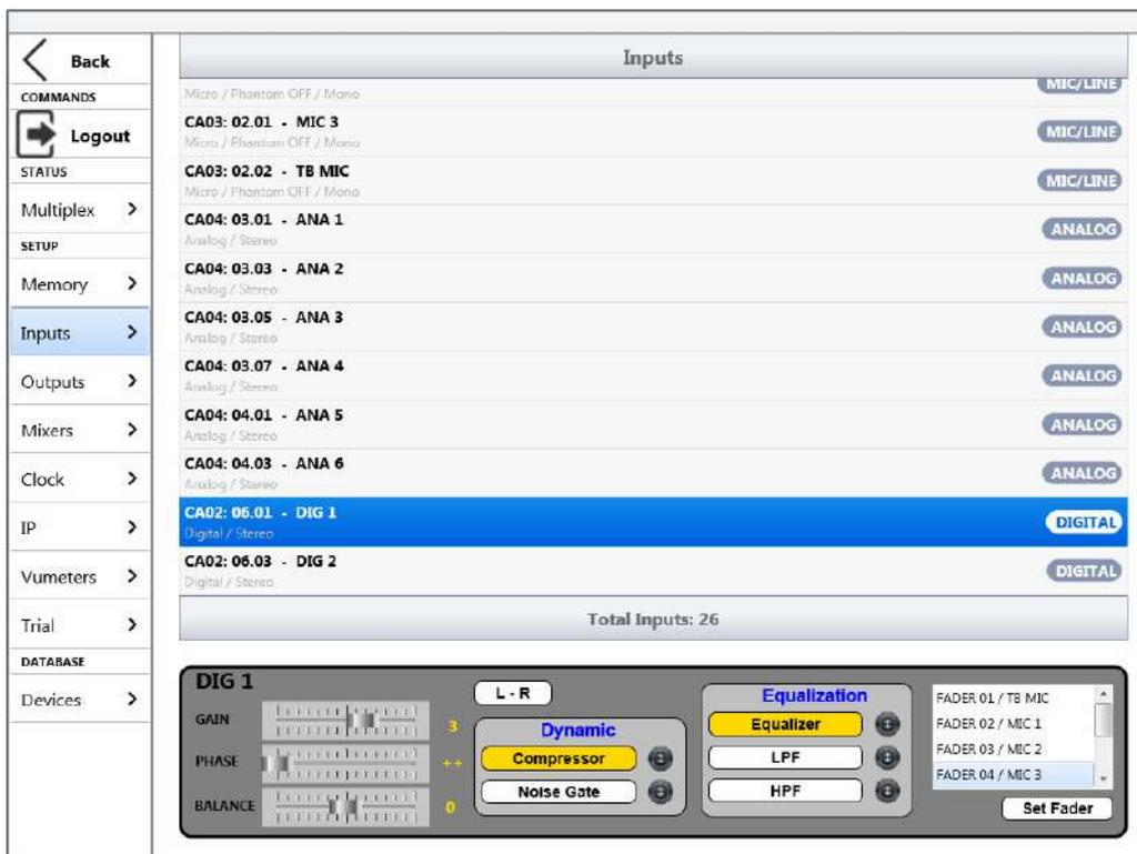
Para cada entrada se indica el tipo de módulo virtual (por ejemplo, digital CA02 o híbrida CA33), su nº de slot virtual (por ejemplo, 06), el nº de canal dentro de ese slot virtual (por ejemplo, 01), el nombre lógico de la entrada (por ejemplo, DIG 1), el tipo de señal (por ejemplo, DIGITAL) y detalles de la configuración (por ejemplo, Digital / Stereo).
