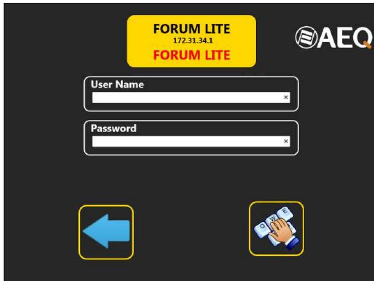
Si se ha activado en la sección de dispositivos (sobre el dispositivo seleccionado) la opción "Auto Login", esta ventana aparece durante unos instantes y, cuando se reciban todos los datos de configuración desde la consola, se pasa automáticamente a la siguiente pantalla. Si no se ha activado esa opción, hay que introducir manualmente usuario y contraseña.
