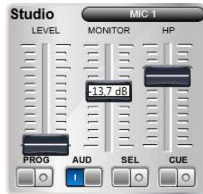
En la parte inferior de la sección de Estudio se encuentran los cuatro botones que conforman, junto con el control "LEVEL", la sección de "TALKBACK". Esta sección permite habilitar el circuito de envío de órdenes a monitores de estudio, auriculares de estudio, híbrido telefónico 1 o híbrido telefónico 2.
