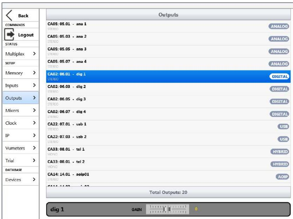
Para cada salida se indica el tipo de módulo virtual (por ejemplo, digital CA02 o híbrida CA33), su nº de slot virtual (por ejemplo, 06), el nº de canal dentro de ese slot virtual (por ejemplo, 01), el nombre lógico de la salida (por ejemplo, dig 1), el tipo de señal (por ejemplo, DIGITAL) y nº de canales de la señal (por ejemplo, STEREO).
