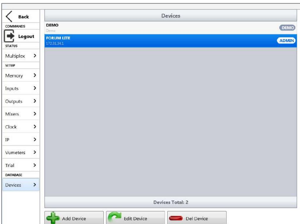
El botón **"Add Device"** permite añadir una nueva consola, el botón **"Edit Device"** permite modificar los parámetros de una consola existente y el botón **"Del Device"** permite eliminar una consola de la lista de dispositivos. El dispositivo "DEMO" (mediante el que se trabajaría contra una consola ficticia) no puede ser editado ni eliminado.
