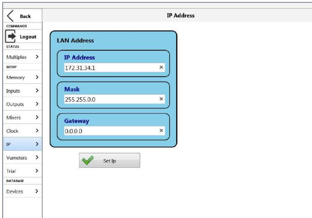
Una vez configurados esos parámetros, mediante el botón "Set Ip" se envían a la consola. Un mensaje informa de que esos cambios no se activarán hasta se apague y encienda la consola.
