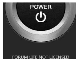
Si la conexión con la consola se ha realizado correctamente, a continuación se verifica si tiene activada la licencia para usar "AEQ FORUM LITE VIRTUAL". La licencia reside en la consola, no en el software, por lo que un mismo software funcionará o no dependiendo de la consola a la que se conecte.
